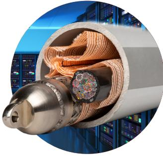
MaxCell Data Center Edge permet l'utilisation d'une plage plus vaste de tailles de câbles et réduit le nombre de conduits requis dans une nouvelle construction. La conception textile flexible brevetée protège l'intégrité de la gaine du câble en évitant la friction des câbles entre eux.
